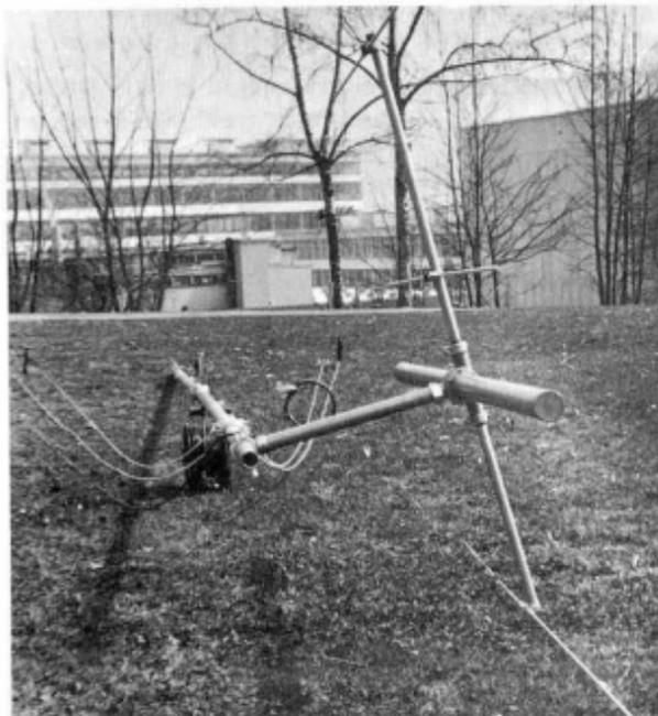
Abb. 6-5 Richtantenne, montiert
